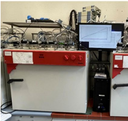
Abbildung: Anaerobe Versuchssysteme z.B. für Gasertragstests industrieller Reststoffe: Batchversuchsstände (links), Laborbogasanlage mit zwei 20-Liter-Fermentern (Mitte) Technikumsbiogasanlage mit zwei 1-m 3 -Fermentern im mobilen Container (rechts).
