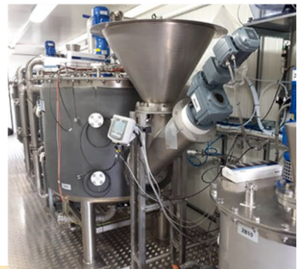
Abbildung: Anaerobe Versuchssysteme z.B. für Gasertragstests industrieller Reststoffe: Batchversuchsstände (links), Laborbogasanlage mit zwei 20-Liter-Fermentern (Mitte) Technikumsbiogasanlage mit zwei 1-m 3 -Fermentern im mobilen Container (rechts).
