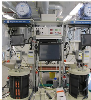
Abbildung: Anaerobe Versuchssysteme z.B. für Gasertragstests industrieller Reststoffe: Batchversuchsstände (links), Laborbogasanlage mit zwei 20-Liter-Fermentern (Mitte) Technikumsbiogasanlage mit zwei 1-m 3 -Fermentern im mobilen Container (rechts).
