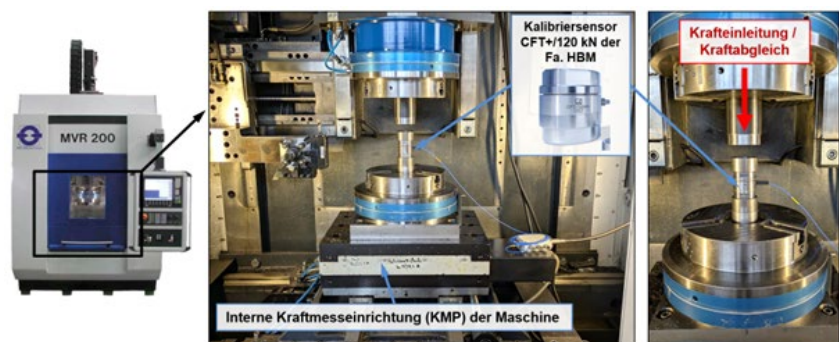
Abbildung: Abgleich des Kraftsignals in der Reibschweißmaschine MVR 200.
