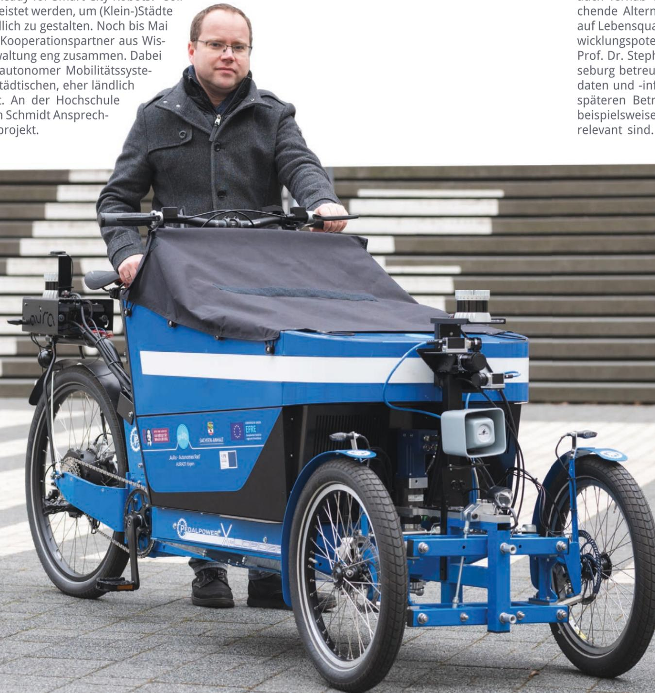
Abbildung: Prof. Dr. Stephan Schmidt präsentiert das an der Hochschule Merseburg im Rahmen des Forschungsprojekts „Ready for Smart City Robots?“ entwickelte hochautomatisierte Lastenrad.
