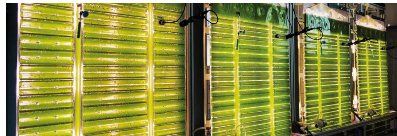
Abbildung: Der Flat Panel Airlift Photobioreaktor wurde speziell für die homogene Durchmischung von Mikroalgen inklusive Cyanobakterien-Kulturen entwickelt. Die Technologie nutzt das Projekt „EVEK“ der Hochschule Anhalt zur Entwicklung eines Verfahrens zur Extraktion langkettiger Kohlenwasserstoffe aus Mikroalgen. Foto: Subitec GmbH
