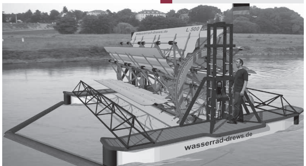
Ein Beispiel für neue Technologien ist das Flusskraftwerk Energy Floater mit Klappschaufelwasserrad, neuartiger Gleitlagerung und integriertem Ringgenerator (Ingenieurbüro H. Drews).
