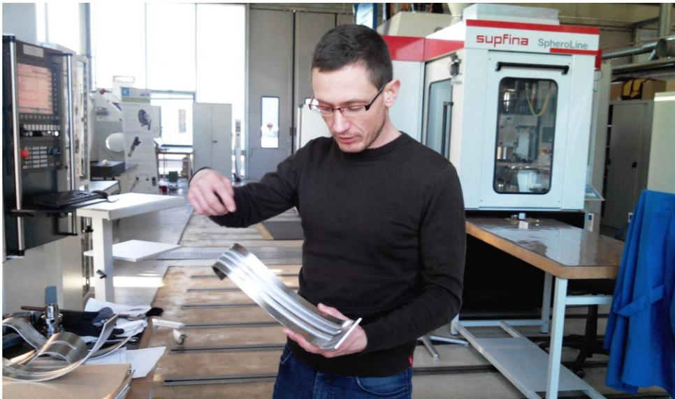
Doktorand Ronny Stolze erklärt am Beispiel, wie durch Rührreibschweißen eine Verbindung hergestellt wird. Im Hintergrund: Die Kugelfinishmaschine Supfina SpheroLine.
