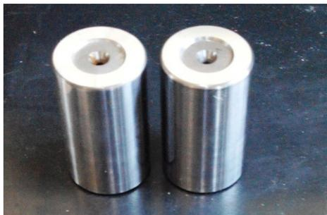
Gefinisierte Walzkörper für ein Zylinderrollenlager.
